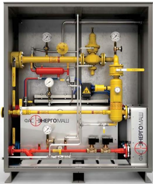
Испарительная установка для сжиженных углеводородных газов (пропан, бутан и их смеси) непрямого жидкостного (водяного) подогрева тип ФЭМ 1900 ZH/SН в шкафном исполнении, с изоляцией и EX-защитным исполнением, с контролем переполнения.
