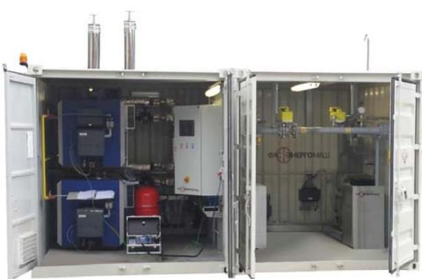
Комбинированная испарительная установка для сжиженных углеводородных газов (пропан, бутан и их смеси) непрямого жидкостного (водяного) подогрева тип ФЭМ 250 ZH/A/K в контейнерном исполнении, с функцией саморазогрева за счет использования котла.
