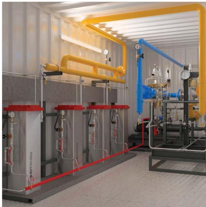
Испарительно-смесительная установка (высокое давление) для сжиженных углеводородных газов (пропан, бутан и их смеси) непрямого жидкостного (водяного) подогрева тип ФЭМ 9600 ISU/ZH/VD/K в контейнерном исполнении.
