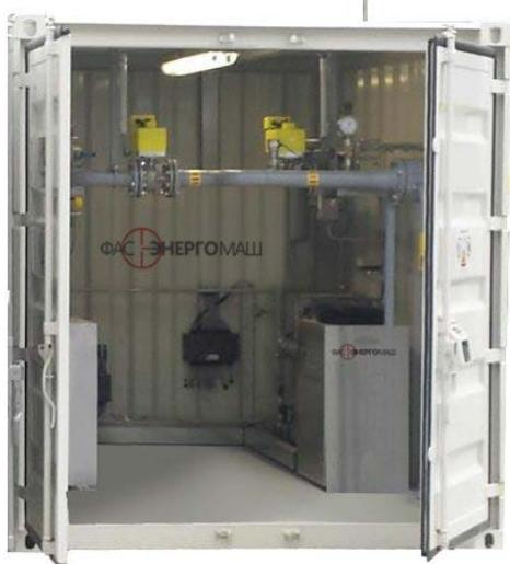
Испарительная установка для сжиженных углеводородных газов (пропан, бутан и их смеси) непрямого жидкостного (водяного) подогрева тип ФЭМ 14000 ZH/K в контейнерном исполнении, максимальной производительностью до 14000 кг/ч с двумя независимыми узлами испарения и регулирования газа с возможностью перехода на аварийный режим мощностью 7000 кг/ч.
