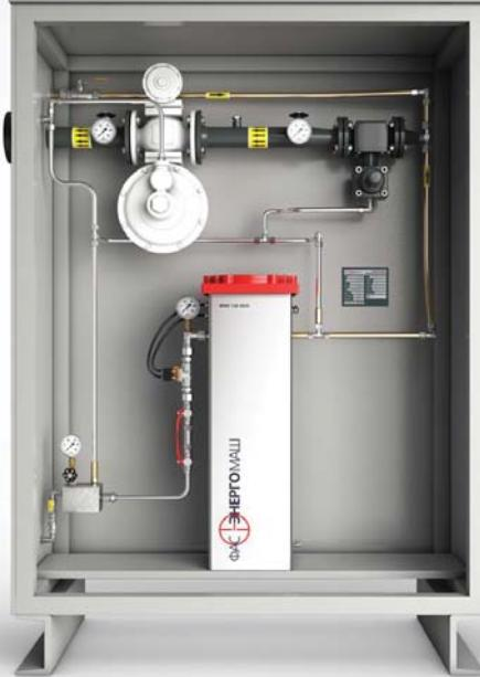
Испарительная установка (среднее давление) для сжиженных углеводородных газов (пропан, бутан и их смеси) непрямого электрического подогрева тип ФЭМ 120 SE/SН в шкафном исполнении.
