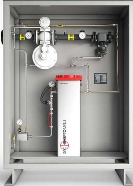
Испарительная установка (среднее давление) для сжиженных углеводородных газов (пропан, бутан и их смеси) непрямого электрического подогрева тип ФЭМ 60 SE/SН в шкафном исполнении.
