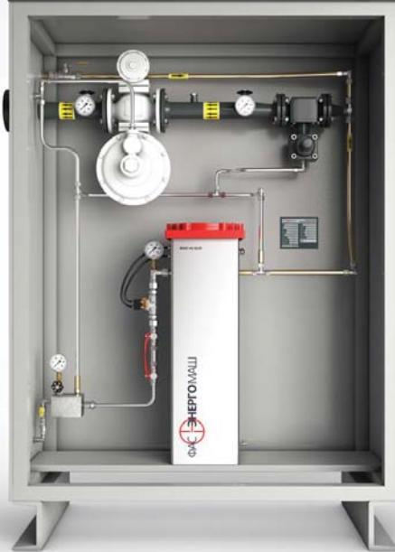
Испарительная установка (среднее давление) для сжиженных углеводородных газов (пропан, бутан и их смеси) непрямого электрического подогрева тип ФЭМ 80 SE/SN в шкафном исполнении.
