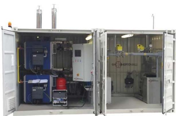
Комбинированная испарительная установка для сжиженных углеводородных газов (пропан, бутан и их смеси) непрямого жидкостного (водяного) подогрева тип ФЭМ 2500 ZH/A/K в контейнерном исполнении, с функцией саморазогрева за счет использования котла.
