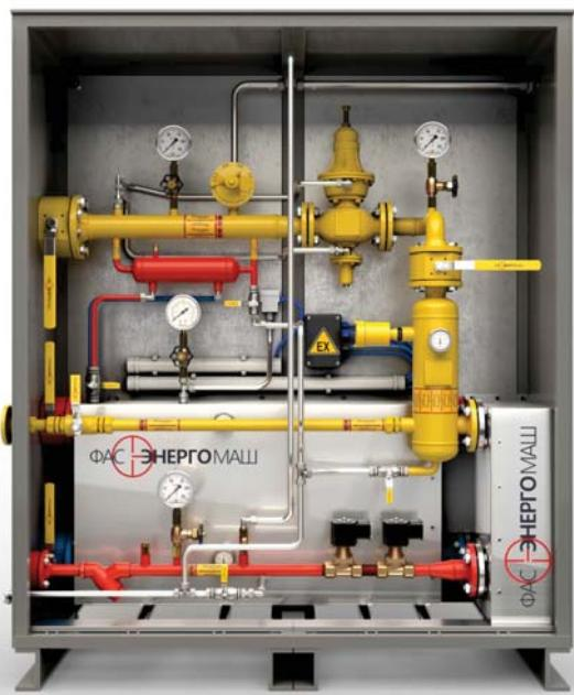
Испарительная установка для сжиженных углеводородных газов (пропан, бутан и их смеси) непрямого жидкостного (водяного) подогрева тип ФЭМ 2500 ZH/SН в шкафном исполнении, с изоляцией и EX-защитным исполнением, с контролем переполнения.
