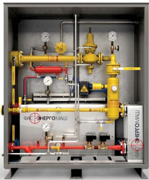
Испарительная установка для сжиженных углеводородных газов (пропан, бутан и их смеси) непрямого жидкостного (водяного) подогрева тип ФЭМ 800 ZH/SH в шкафном исполнении, с изоляцией и EX-защитным исполнением, с контролем переполнения.
