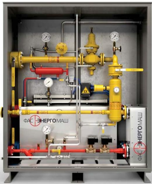
Испарительная установка для сжиженных углеводородных газов (пропан, бутан и их смеси) непрямого жидкостного (водяного) подогрева тип ФЭМ 3800 ZH/SН в шкафном исполнении, с изоляцией и EX-защитным исполнением, с контролем переполнения.
