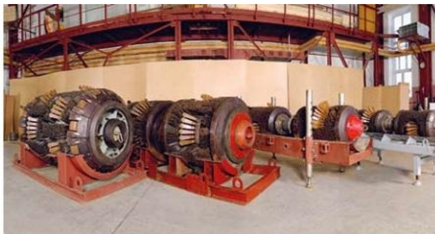
Рис. 1. Дефектоскопы с поперечно приложенным магнитным полем различного диаметра
