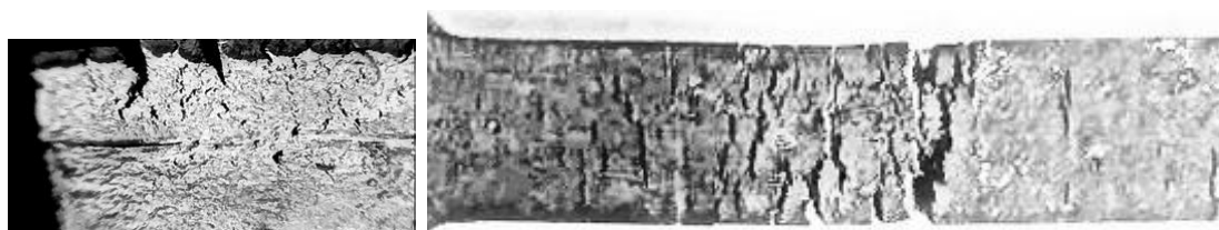
Рис. 24. Внешний вид поверхности образца после испытаний на растяжение
