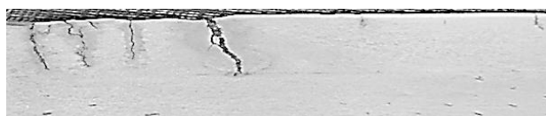
Рис. 13. Колония трещин у поверхности образца из стали X70
